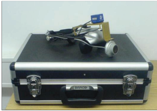
Abbildung 2: Foto des verwendeten eMagin Z800 HMD mit einer angebrachten USB-Kamera.
